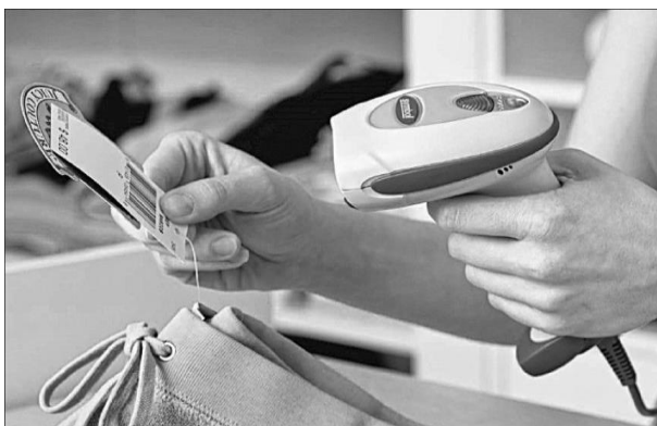
2.36 -сурет. Қол сканері
