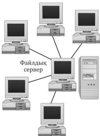
5.5 -сурет. Жұлдыз түріндегі топология желісі
