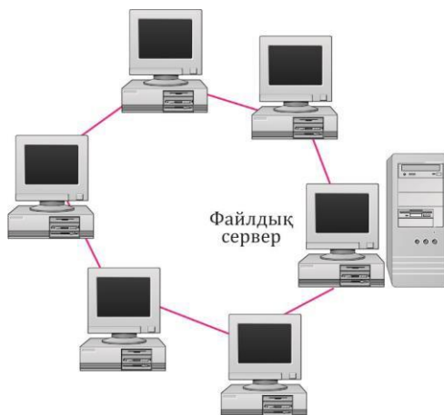
5.4 -сурет. Сақина түріндегі топология желісі
