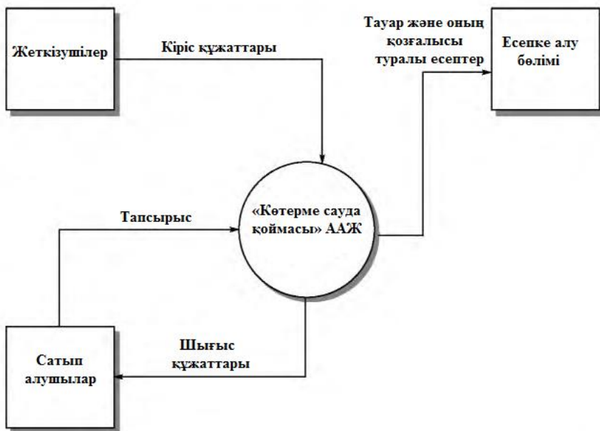
4.6-сурет. «Көтерме сауда қоймасы» ААЖ үшін Йордан нотациясындағы бастапқы мәнмәтінді диаграмма (нөлдік деңгей диаграммасы)
