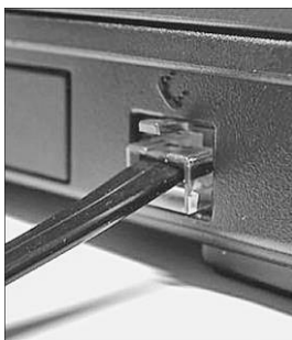
1.53-сурет. RJ11 модем интерфейсі
