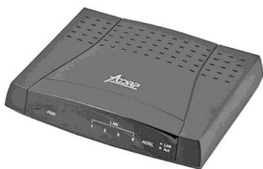
Сурет - 1.31. Сыртқы (а) және ішкі (б) модемдер
