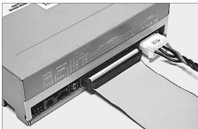
1.63-сурет. DVD-сымдарының қосылуы (шлейфтегі қызыл жолақ үнемі қорек көзі жалғағышы нық қасында в орналасуы керек)
